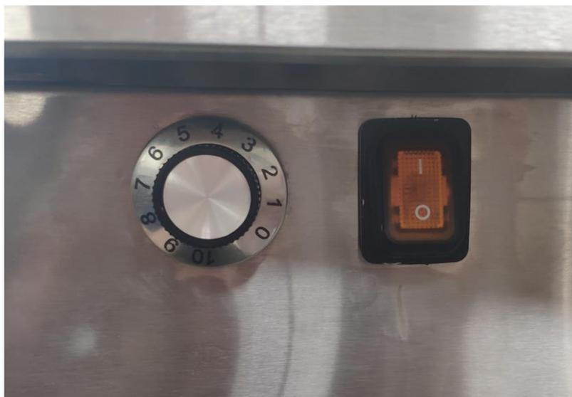
3. Вернуть ручку терморегулятора против часовой стрелки для установки требуемой температуры нагрева (см. Рис. 2).
